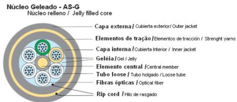
Figura 5.7 – Exemplo de Cabo de Fibra Óptica do tipo AS.
