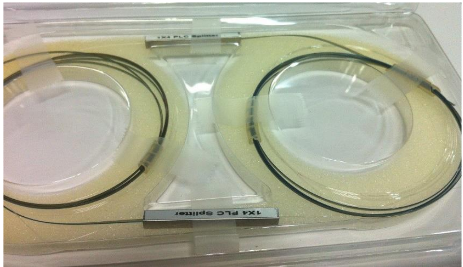
Figura 5.11 – Exemplo de Splitter Óptico PLC não conectorizado.
